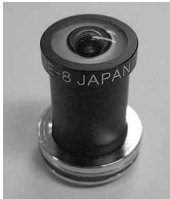
図2 全天カメラに取り付けた魚眼コンバージョンレンズ (魚露目 8 号, フィット社)。
