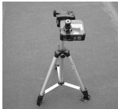
図3 全天カメラを野外に設置した様子。三脚に設置したカメラを天頂に向ける。また、カメラの向きは南北方向にあわせる。
