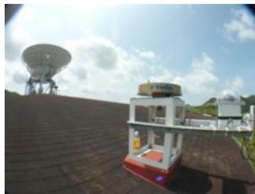
屋根屋上からGPS用やぐら(写真中央、金色の円柱部がGPSアンテナ)に設置された全天カメラ(右端)とVERAアンテナ(左端)を望む。
