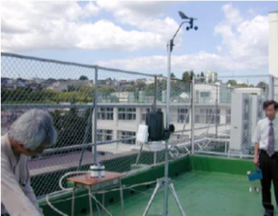
三条中に設置した気象観測装置
