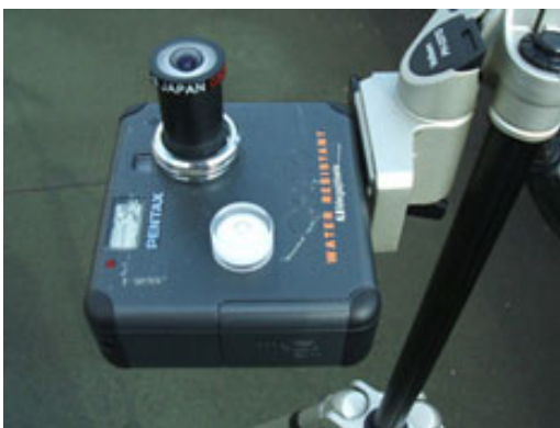
図1 全天カメラ概要。デジタルカメラに市販デジタルカメラ用魚眼レンズをつけ、さらに水準器を貼り付けている。
