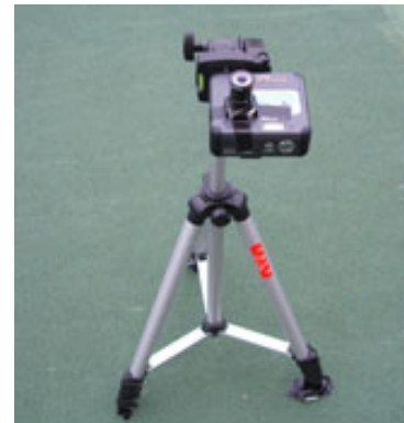
図3 全天カメラを野外に設置した様子。三脚に設置したカメラを天頂に向ける。また、カメラの向きは南北方向にあわせると後の解析がやりやすい。
