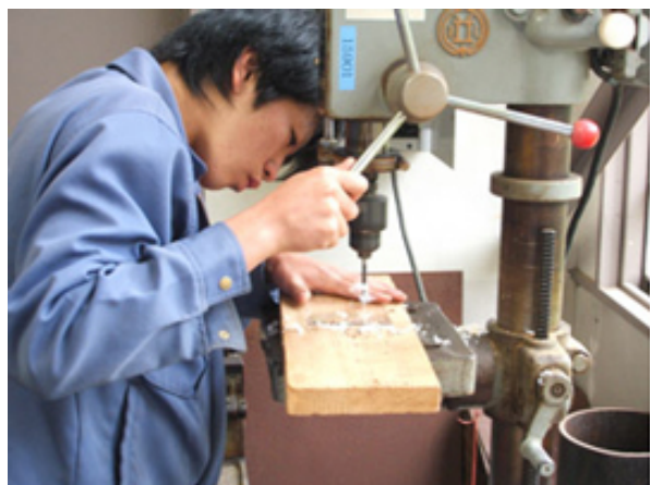
図3 アクリル板に穴を開けている
