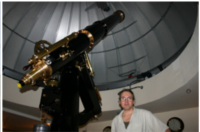
約150年前の口径20cm屈折望遠鏡
