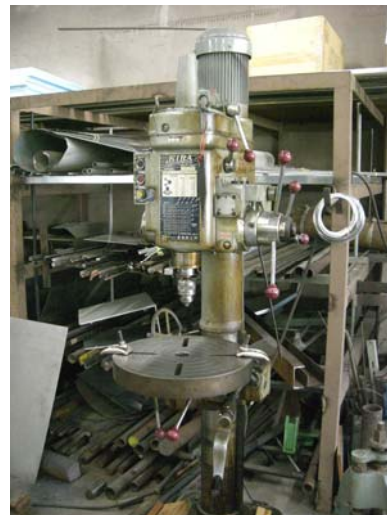
図 2-5 アルミアングルの切断に使用したバンドソー(左)とネジ穴を空けるために使用したボール盤(右)。バンドソーを用いて長さ 1m の 2 本のアルミアングルを 10 本に切断した。ボール盤を用いてステンレス板、アルミアングル、透明半球と保護ボックスに穴を空ける作業を行った。
