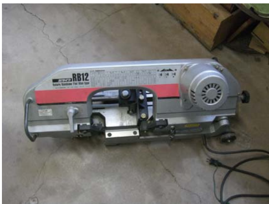
図 2-5 アルミアングルの切断に使用したバンドソー(左)とネジ穴を空けるために使用したボール盤(右)。バンドソーを用いて長さ 1m の 2 本のアルミアングルを 10 本に切断した。ボール盤を用いてステンレス板、アルミアングル、透明半球と保護ボックスに穴を空ける作業を行った。
