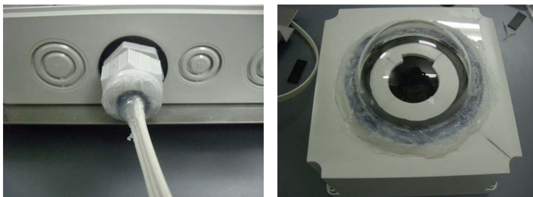
図 3-8 カメラハウジングのケーブル口(左)とレンズ口と固定した透明半球(右)。ケーブルとケーブルグランドの隙間を埋めるためにシリコンで塞いだ(左)。保護ボックスにレンズ口をあけ、それを覆うように透明半球を固定した。浸水を防ぐため、透明半球と保護ボックスの隙間をシリコンで塞いだ(右)。
