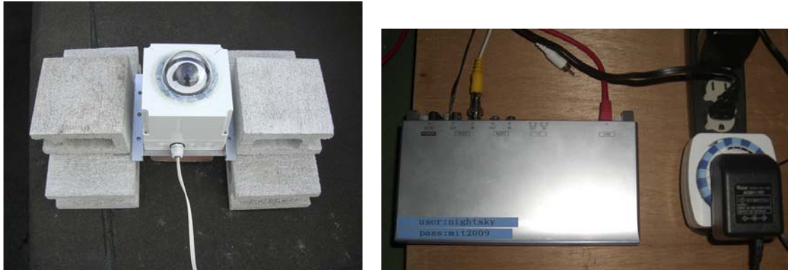
図 3-11 設置した星空ライブカメラ(左)と天文台内のネットワークカメラサーバーとプログラムタイマー(右)。星空ライブカメラからのびているケーブルは、天文台内で 2 本に分かれてそれぞれネットワークカメラサーバーと AC アダプタに接続している。AC アダプタをプログラムタイマーに接続し、タイマーをコンセントに接続する。
