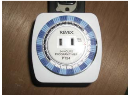
図 3-10 プログラムタイマー(PT24)。24 時間の目盛りが環形に分けられており、青い目盛りを上下させることで ON、OFF の時間を設定することが可能。右側の赤い矢印に現在の時間の目盛りを合わせ、コンセントに挿すことでタイマーがスタートする。プログラムタイマーにカメラの AC アダプタを接続することでカメラの電源がコントロールされる。
