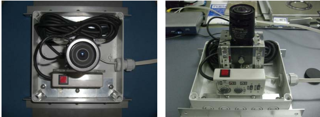
図 3-9 保護ボックス内部の様子(左：上部から、右：側面から)。カメラはアクリル製 L 字アングルにねじで固定している。さらに垂直を維持し、横ずれを防ぐためにアルミ板を加工して取り付けて固定している。ボックス内にはカメラ本体とコントローラーのみ入れ、その他の機器は屋内に設置した。
