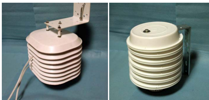
図4-8 ラジエーションシールド 市販(左)と自作(右)
