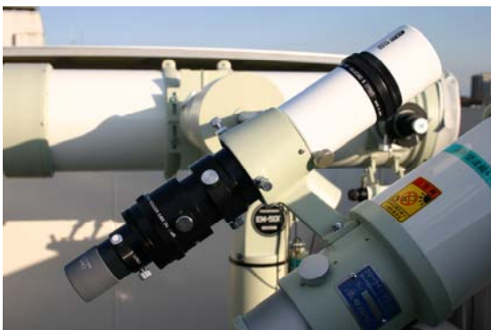
図 2. 天体望遠鏡トミーテック社 miniBORG45ED(口径:45mm 焦点距離:255mm)
