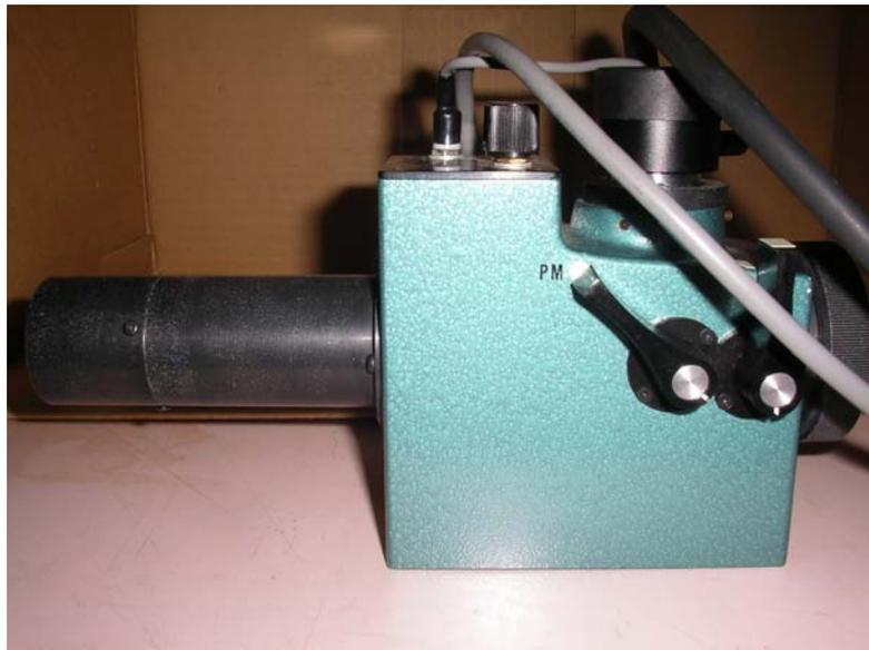
図 2-2-1 光電子測光装置
