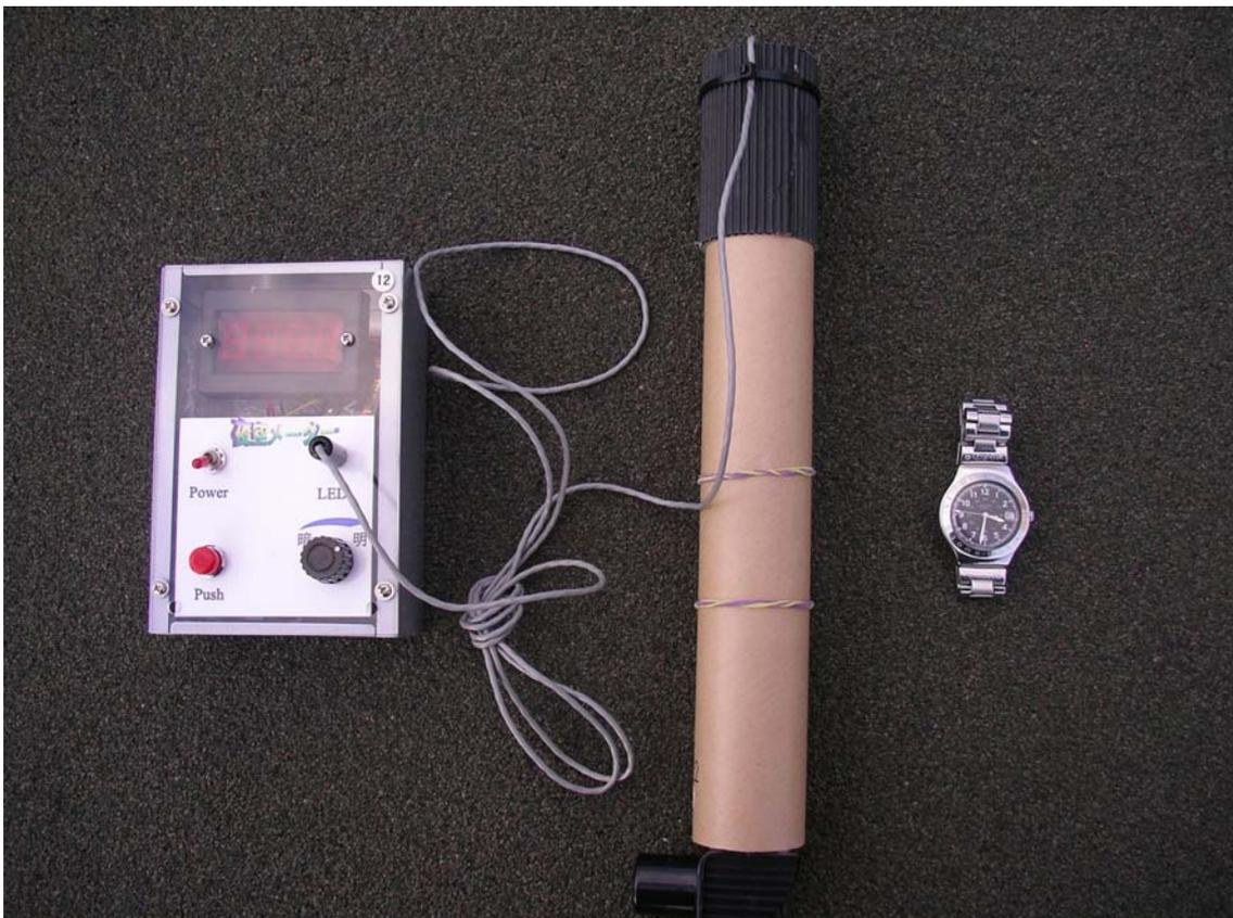
図 2-1-1 夜空メーター 写真左が回路部、写真右側が光学系
