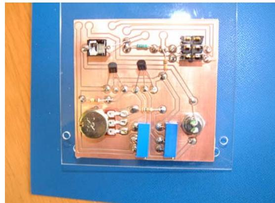
図 2-3-2 ハンダ付けした基板
