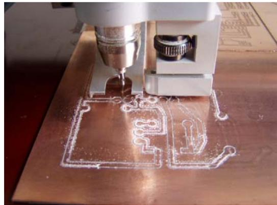
図 2-3-4 回路図データを削る基板製作機
