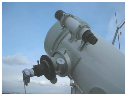
図 2-6 望遠鏡の接眼部に Web カメラを設置した様子
