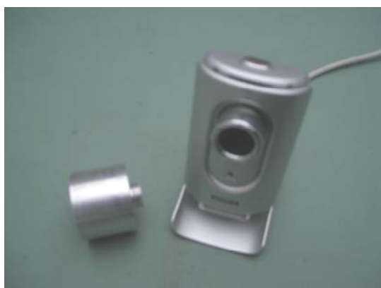
図 2-5 使用した Web カメラ (Phillips 社) と望遠鏡に接続するアダプタ (左)。レンズを取り外し、アダプタを装着する。
