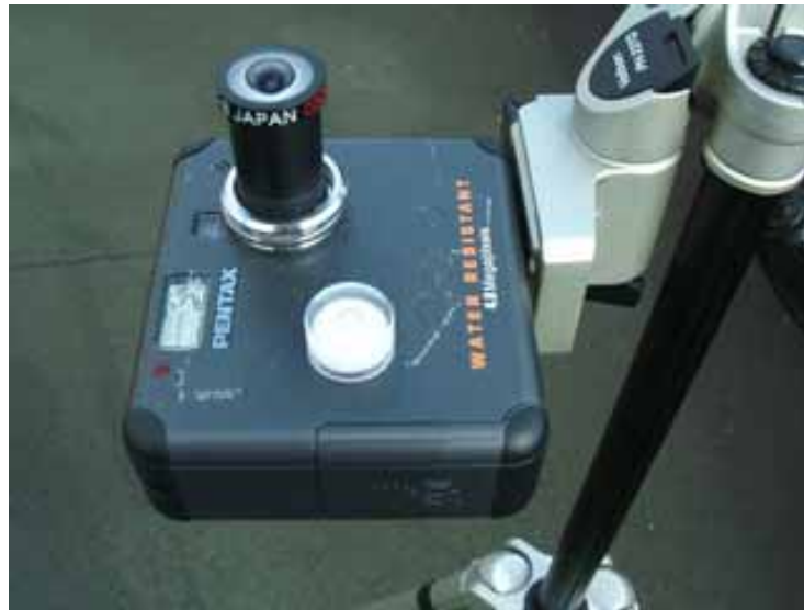
図 18 全天カメラ（デジタルカメラに魚眼レンズを装着している）
