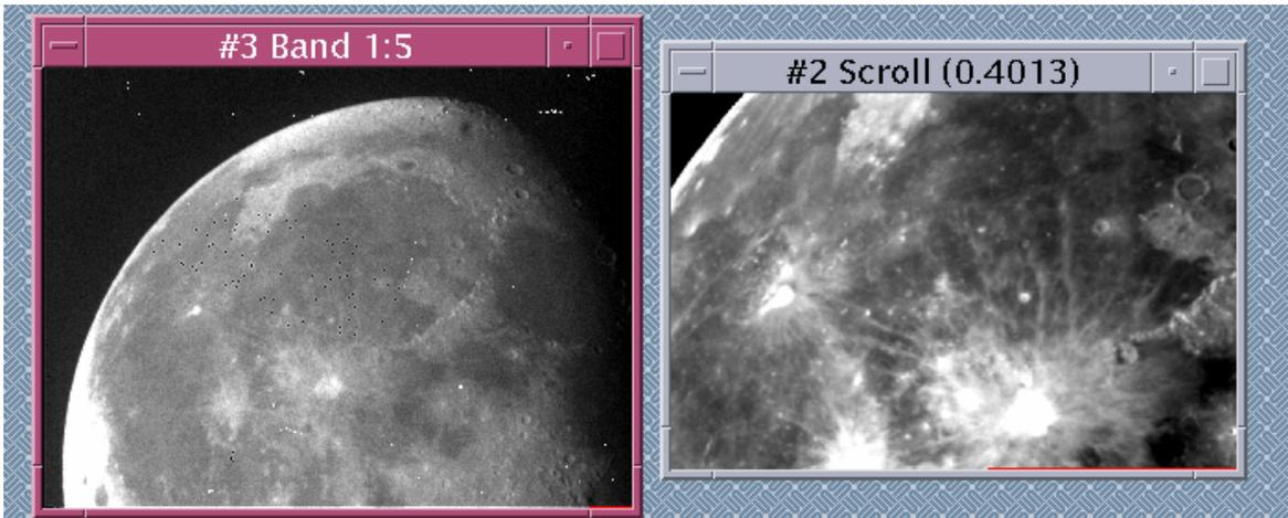
Fig 3-6 実際にフードを装着して月面撮像を行った画像である.フードによる光路・視野の妨害はないことがわかる.
