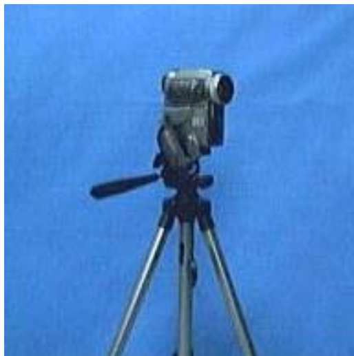
図 2-2-4 メッセンジャーでの中継に用いるハンディカム（SONY 社 DCR-PC120） 暗い中でも対象物を撮影することができる「スーパーナイトビジョン」機能を持つ SONY 社のハンディカム DCR-PC120。天体観測の妨げとなるあかりがなくとも、望遠鏡を撮影・中継することができる。
