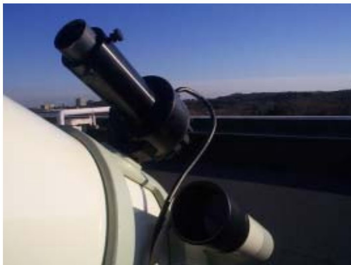
図 2-2-5 広角冷却 CCD カメラ (SBIG 社 ST-237)
