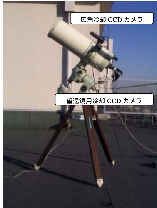
図 2-2-2 遠隔操作望遠鏡と冷却 CCD カメラ
