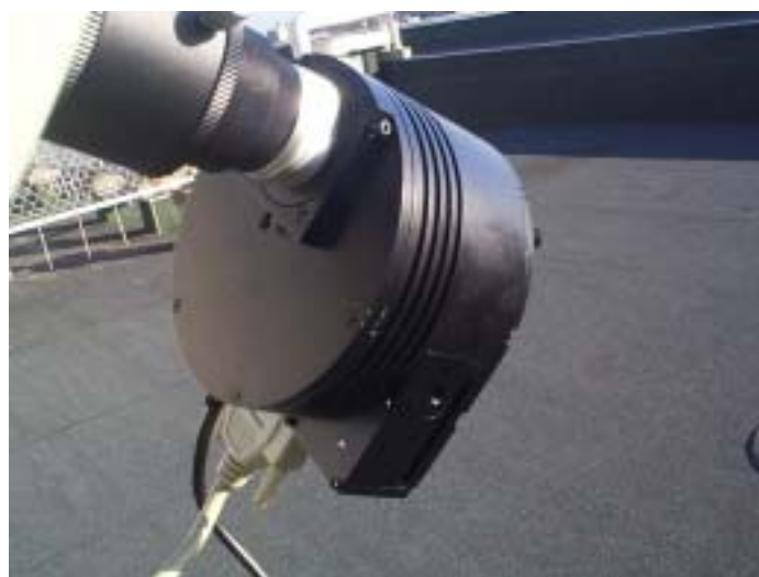
図 2-2-3 望遠鏡用冷却 CCD カメラ (SBIG 社 ST-7)
