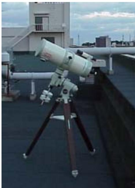
図 2-3 口径 20 c mカセグレングレン望遠鏡
